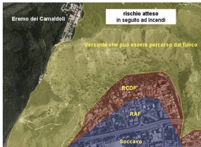
Fig. 5 Il rischio atteso dopo gli incendi, non previsto dagli elaborati dell'Autorità di bacino. RCDF = rischio connesso a scorrimento di flussi detritico-fangosi. RAF = rischio connesso a scorrimento di acqua fangosa.
