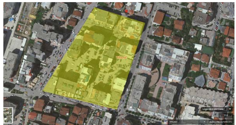
Figure 9: Open block systems, Komuna e Parisit, Tirana. S. Area = 17 100 m 2 | S. Constructible = 6 700 m 2 | S. total area = 67 000 m 2 | height = 10 floors | FAR = 3,9 | v S. Green = 2%
