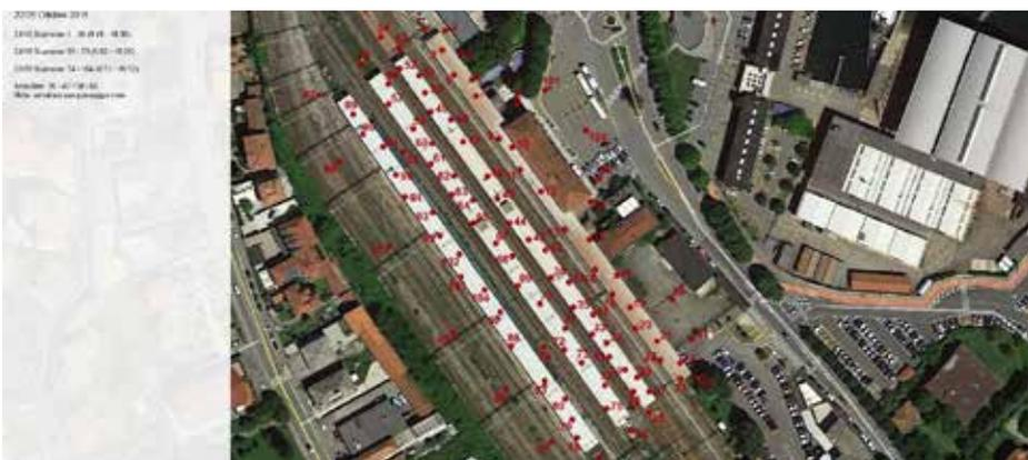
9 Immagine planimetrica dei punti acquisiti col Laser Scanner Faro Focus 3D X330 HDR
