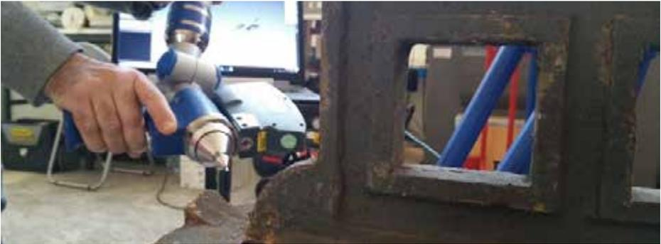
17 Acquisizione dell'elemento, presso la sede di Benecon, con il braccio di misura FaroArm Platinum
