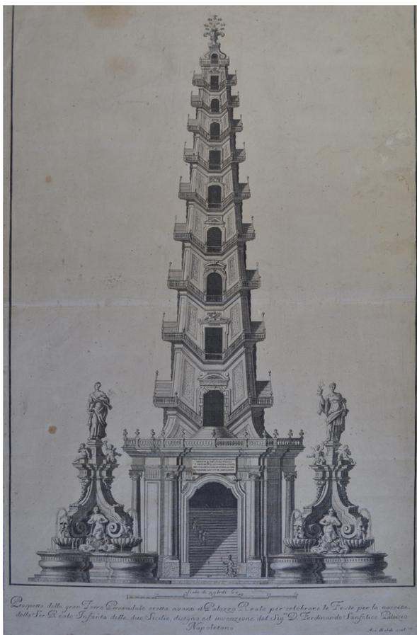
un prisma di forma ottagonale irregolare, la cui altezza in proporzione è uguale a quella del recinto. Su di essa si slancia una piramide con analoga base ottagonale irregolare, raccordata con elementi curvilinei alla base. Sulla suddetta torre è possibile individuare numerosi elementi caratterizzanti la poetica
