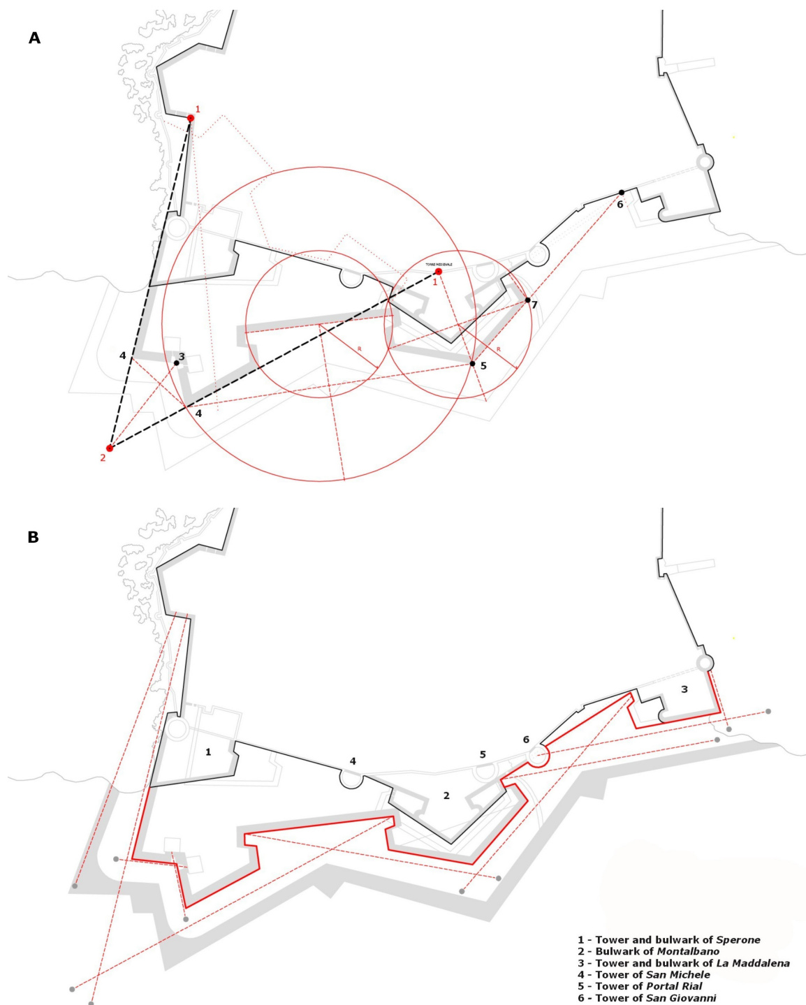
Fig. 160. Ampliamento del fronte di terra di Alghero proposto da Giorgio Paleari nel 1573. Rielaborazione e analisi grafica del documento d'archivio.
