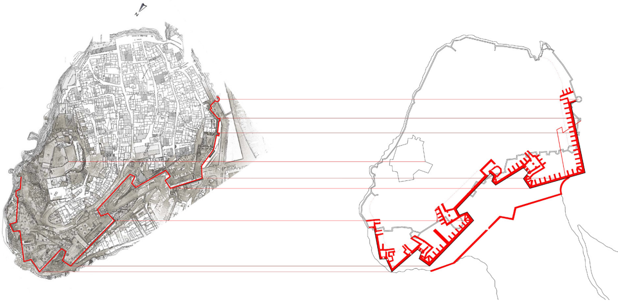
Fig. 77. Fortificazioni di Peñíscola (Spagna). Raffronto tra rilievo laser scanner e rielaborazione grafica del documento d'archivio (AGS, MPD, 09, 057).
